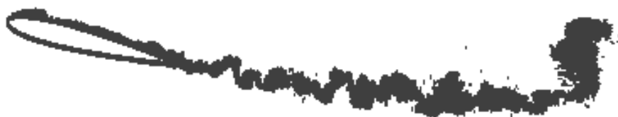
Figura A.52 – Esteira Re = 10^5 , \alpha = 14^\circ , t = 2,5
