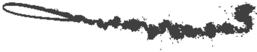
Figura A.39 – Esteira Re = 10^5 , \alpha = 10^\circ , t = 2,5
