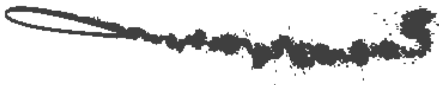
Figura 7.12 – Esteira Re = 10^5 , \alpha = 10^\circ , t = 2,5
