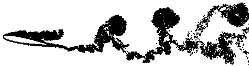
Figura 5.28 – Esteira de um aerofólio NACA 0012 com 10^\circ de ângulo de ataque
