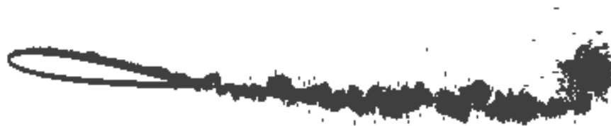
Figura A.32 – Esteira Re = 10^5 , \alpha = 8^\circ , t = 2,5
