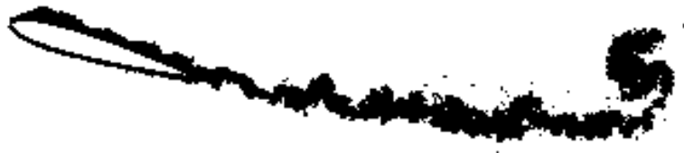
Figura B 60 – Esteira Re = 10^4 , \alpha = 16^\circ , t = 2,5
