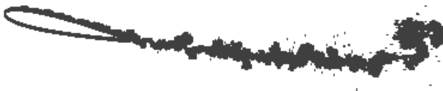
Figura A.46 – Esteira Re = 10^5 , \alpha = 12^\circ , t = 2,5
