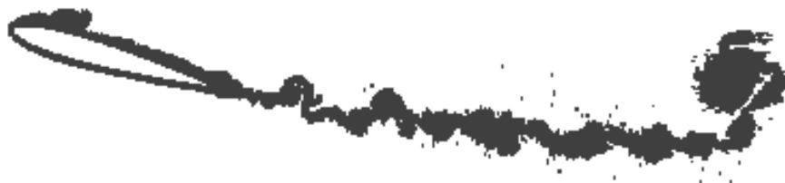
Figura A.59 – Esteira Re = 10^5 , \alpha = 16^\circ , t = 2,5
