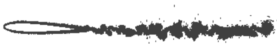
Figura A.11 – Esteira Re = 10^5 , \alpha = 2^\circ , t = 2,5
