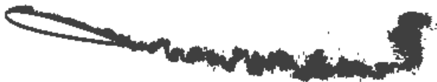
Figura 7.19 – Esteira Re = 10^5 , \alpha = 14^\circ , t = 2,5
