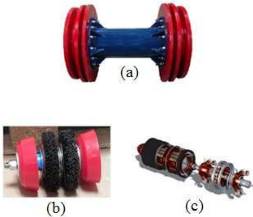
Figura 5.1. Tipos de *PIG* (Fontes: 4pipe e PhDutos): (a) *PIG* de disco bidirecional; (b) *PIG* de copo de limpeza; (c) *PIG* instrumentado (*smart PIG*)
