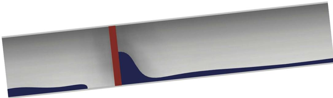
Figura 5.6. Representação gráfica da interação *pig*/escoamento na linha
