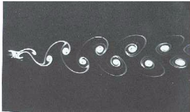
Figura 1.4 – Escoamento em torno de um cilindro circular para Re = 55
