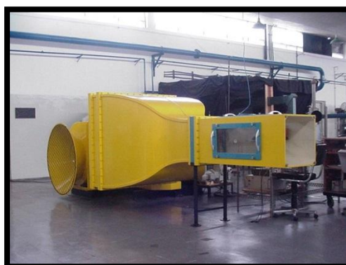
Figura 4.10: Foto túnel aberto e no detalhe o bocal. Fonte: CTA – ITA.
