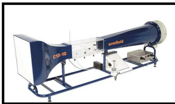
Figura 2.6: Túnel de vento circuito aberto de sucção. Fonte: Armfield.
