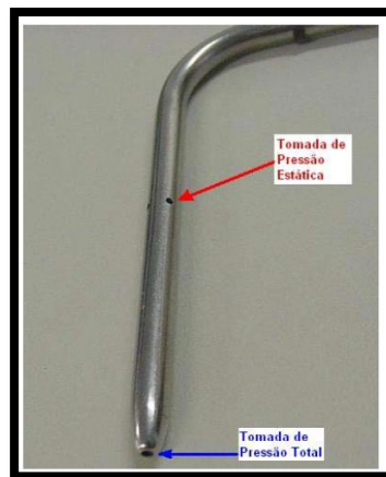
Figura 2.1: Tubo de Pitot 1. Fonte: Túnel de vento subsônico- CTA- ITA.
