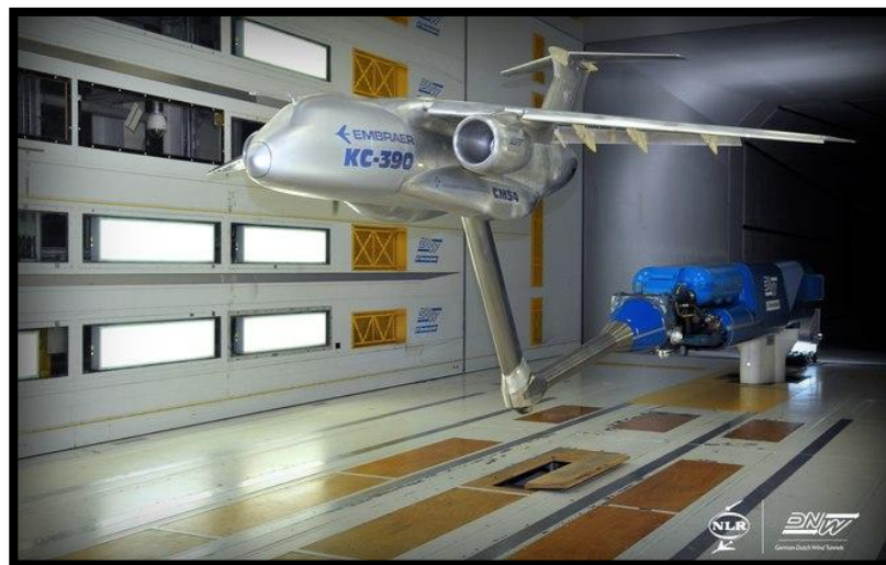
Figura 4.1: Modelo avião KC-390 Embraer dentro da seção de teste de um túnel de vento. Fonte: NLR e DNW – Alemanha.
