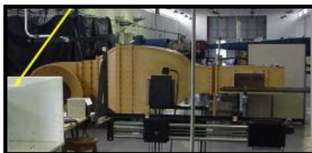
Figura 2.8: Túnel de vento circuito aberto tipo soprador. Fonte: ITA.
